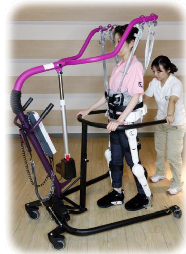
図：HAL福祉用と免荷機能付歩行器（オールインワン）を用いた歩行訓練。 （CYBERDYNE社ホームページ http://www.cyberdyne.jp/aio/ から引用）
